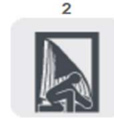
2 Colocar la tela empezando por un extremo.
